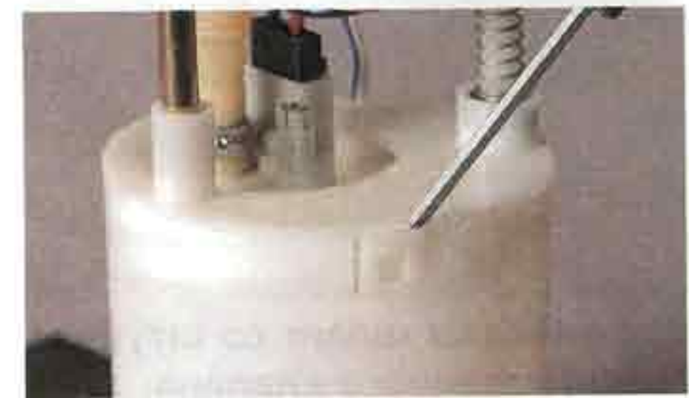
Отверткой отжимаем три фиксатора на корпусе топливного модуля...
