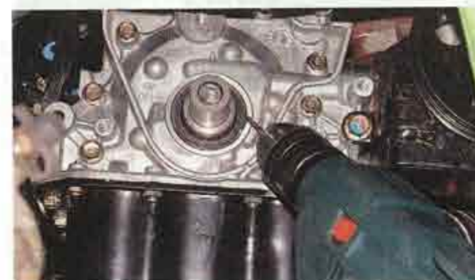
...сверлим в торце металлической обоймы сальника два отверстия диаметром 2–3 мм на глубину не более 2–3 мм.
