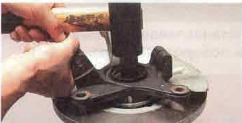
Удерживая поворотный кулак на весу и нанося удары молотком по оправке...
