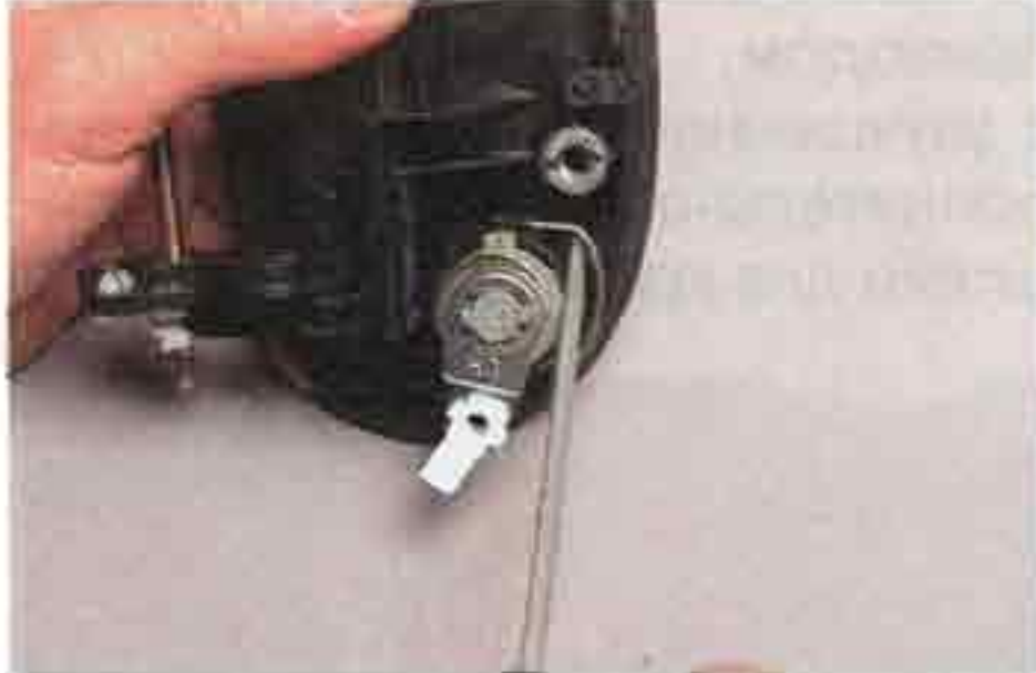
...с помощью отвертки снимаем пружинный фиксатор...
