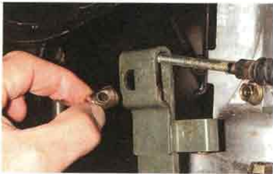
Вынимаем втулку крепления троса из рычага.
