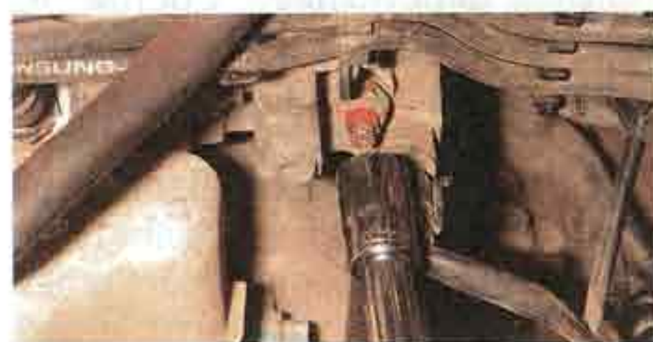
Головкой «на 13» отворачиваем датчик.
