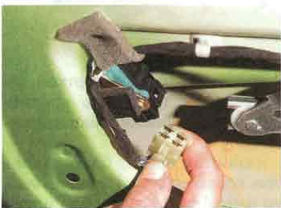
Отсоединяем колодку жгута проводов от контактного разъема привода блокировки.
