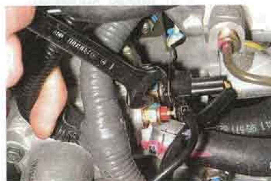
Ключом «на 13» отворачиваем датчик указателя температуры охлаждающей жидкости...
