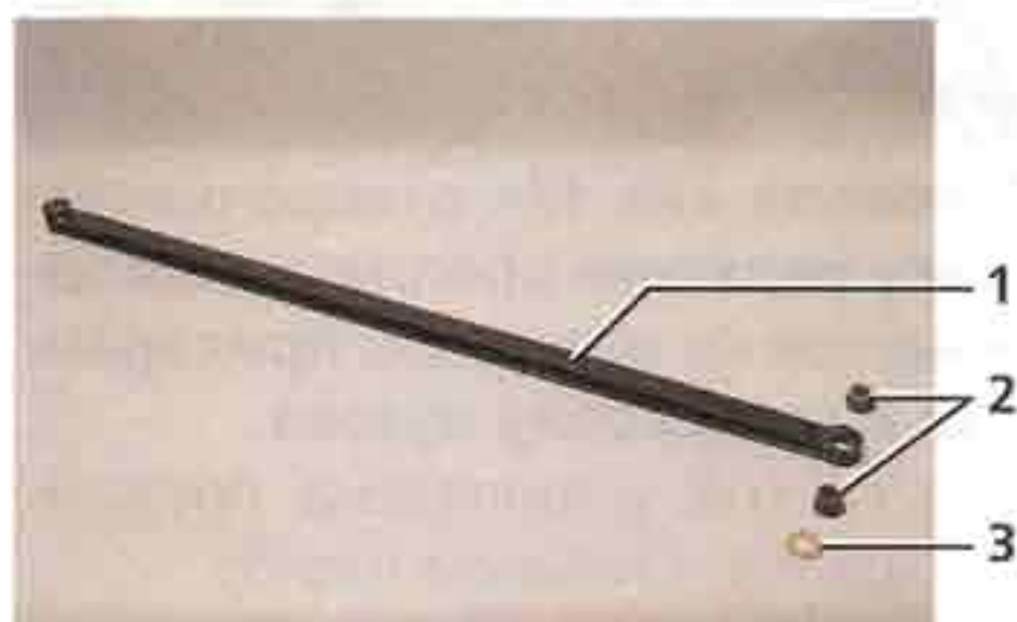
Поперечная штанга задней подвески: 1 — поперечная штанга; 2 — резиновые втулки нижней проушины; 3 — плоская шайба
