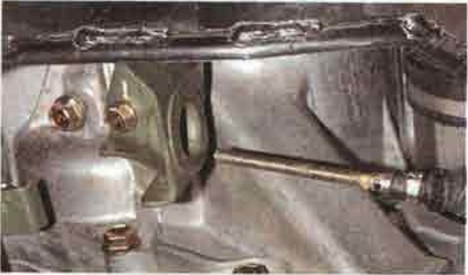
Выводим трос из кронштейна на картере коробки передач. В салоне автомобиля под панелью приборов...
