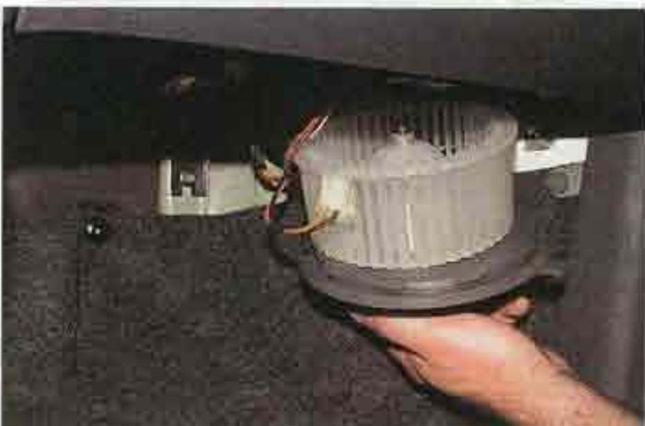
...поворачиваем вентилятор против часовой стрелки и снимаем его. Устанавливаем вентилятор в обратной последовательности.
