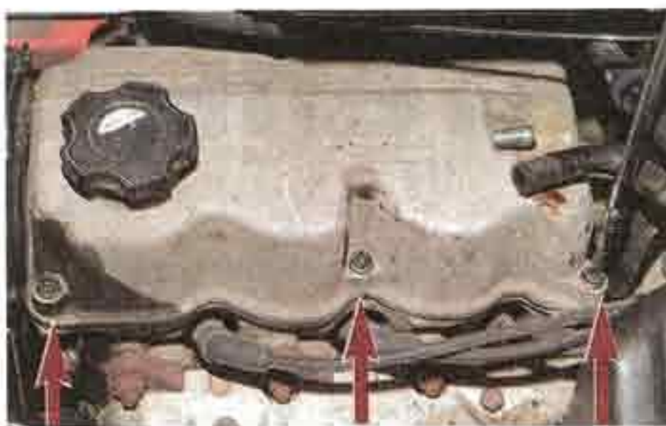
Шестигранником «на 5» отворачиваем шесть винтов крепления крышки головки блока цилиндров (три из них расположены в передней части крышки, три — в задней)...
