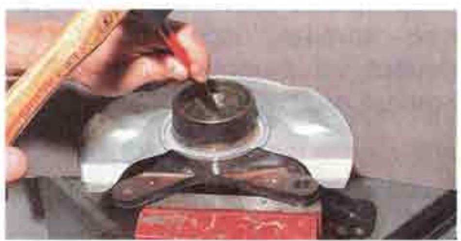
С помощью выколотки выбиваем наружное кольцо внутреннего подшипника, переставляя выколотку крест-накрест.
