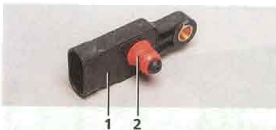
Датчик абсолютного давления воздуха во впускном трубопроводе: 1 — датчик; 2 — уплотнительное кольцо
