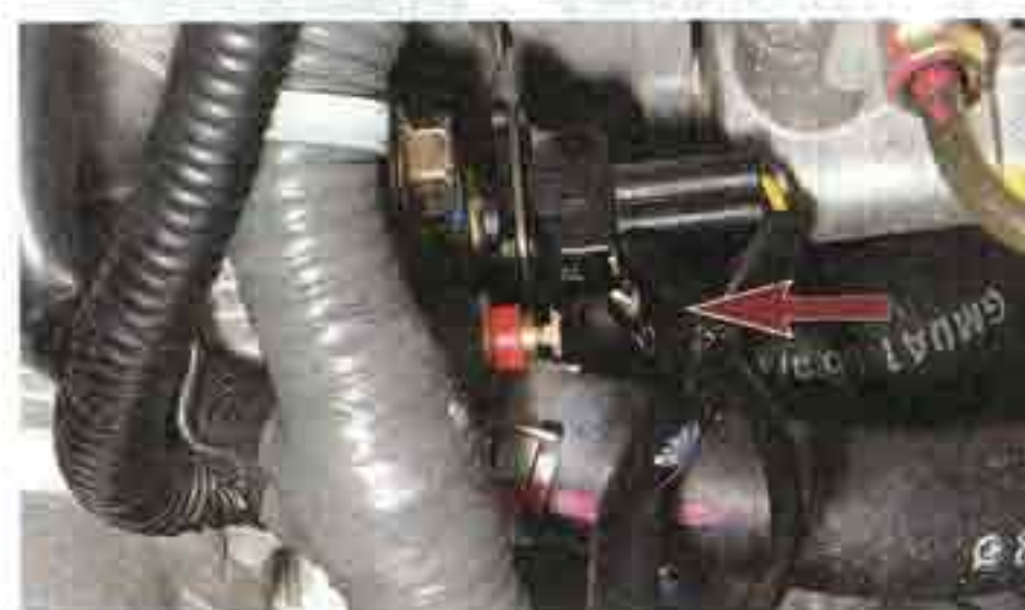
Сдвигая, отсоединяем от вывода датчика колодку провода (показана стрелкой).
