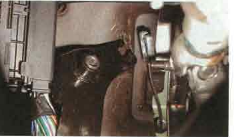
Снимаем наконечник троса с педали.
