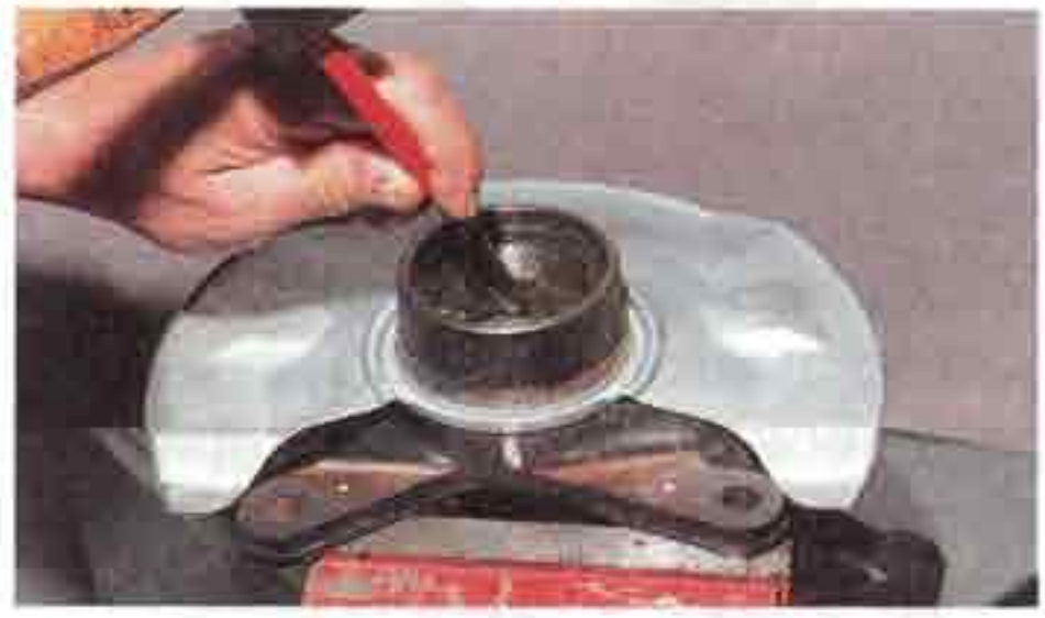
...и молотком через выколотку наносим удары по внутреннему кольцу внутреннего подшипника.
