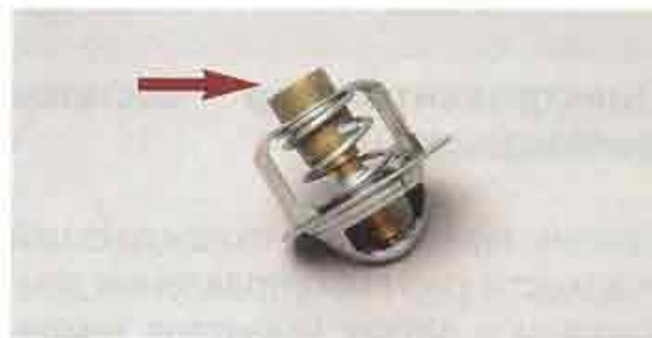
Термостат (стрелкой показан термочувствительный элемент)
