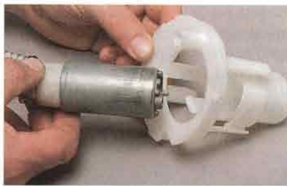
...и вынимаем топливный насос из держателя.
