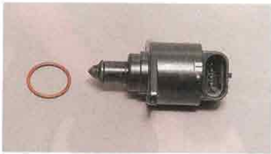
Регулятор холостого хода двигателя 0,8 л
