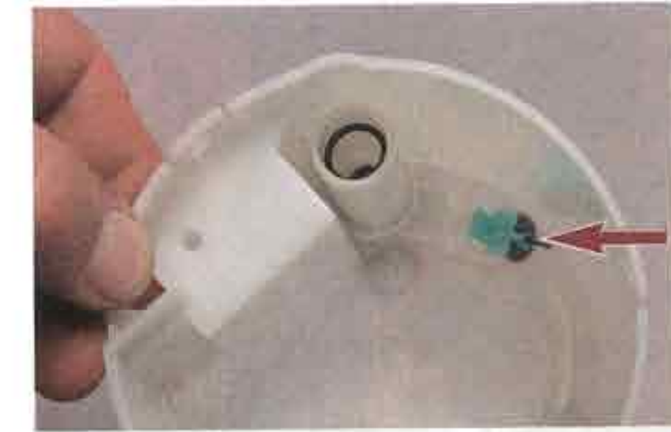
В корпусе топливного модуля установлен клапан, препятствующий вытеканию топлива в бак.
