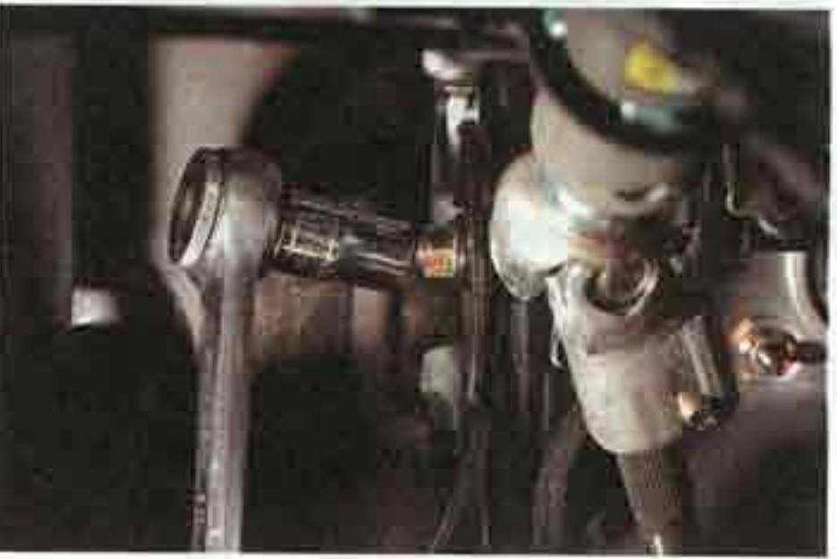
...головкой «на 14» отворачиваем гайку крепления педали сцепления.
