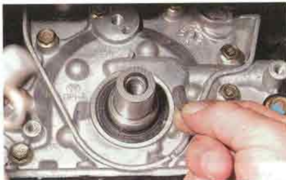
Вынимаем сегментную шпонку из паза коленчатого вала.
