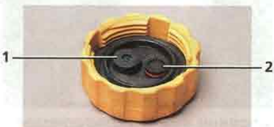
Клапаны в пробке расширительного бачка: 1 — выпускной клапан; 2 — впускной клапан
