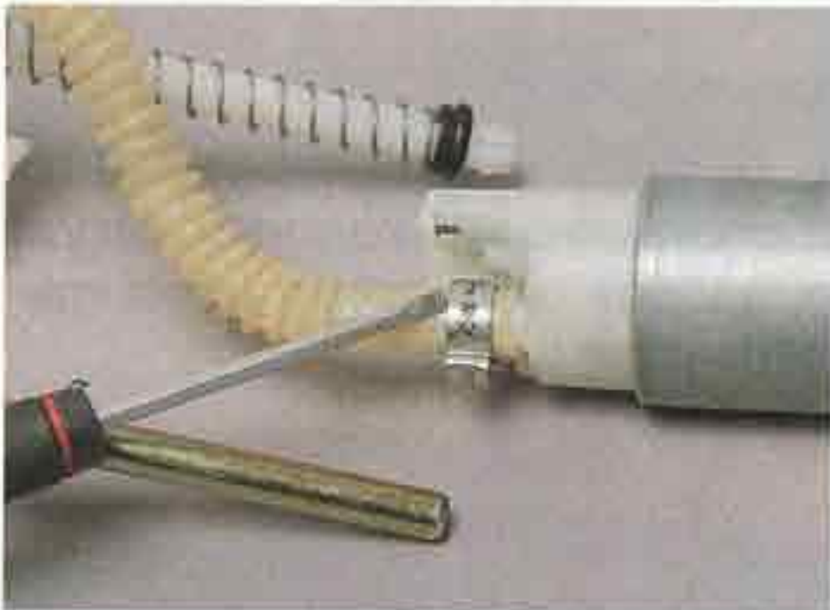
Отверткой отгибаем лапки хомута на гофрированной топливной трубке...
