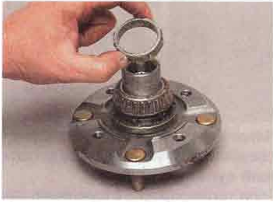
Снимаем распорную втулку подшипников со ступицы.
