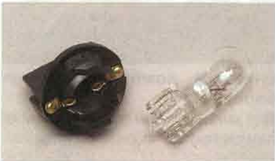
Для замены лампы извлекаем ее из патрона.
