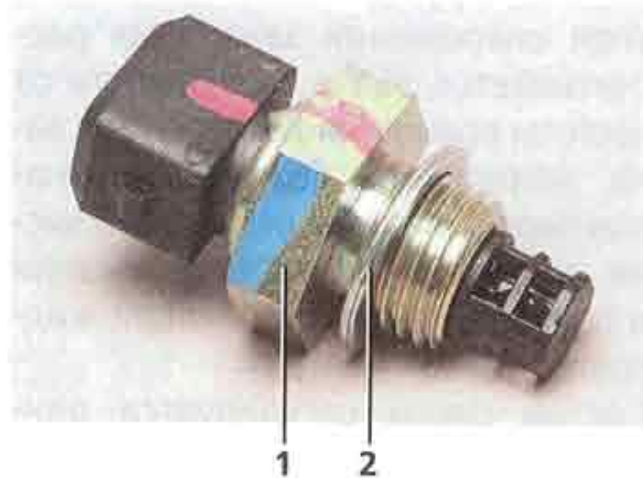
Датчик температуры воздуха во впускном трубопроводе: 1 — датчик; 2 — уплотнительное кольцо
