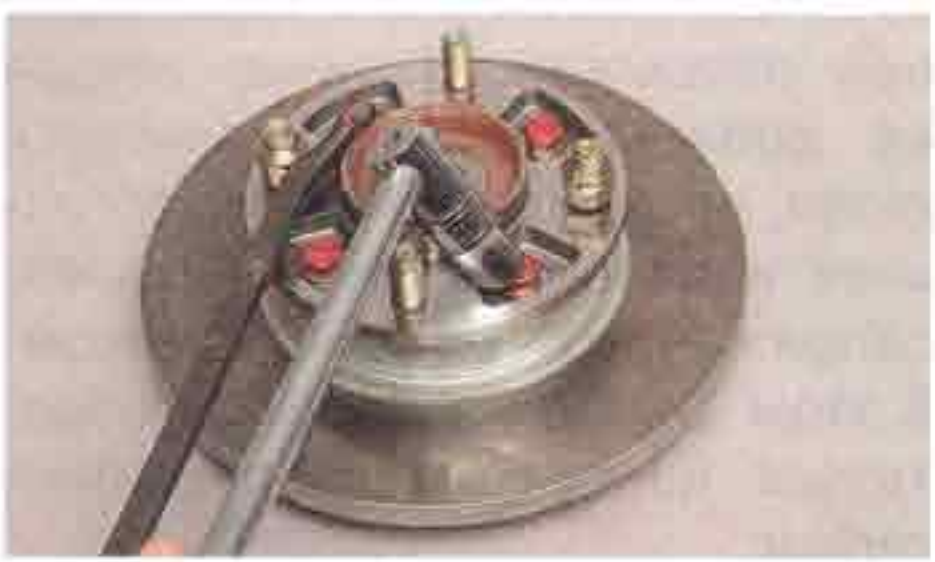
...и, вставив монтажную лопатку между буртиком ступицы и гайкой, головкой «на 14» отворачиваем четыре болта крепления тормозного диска к ступице.
