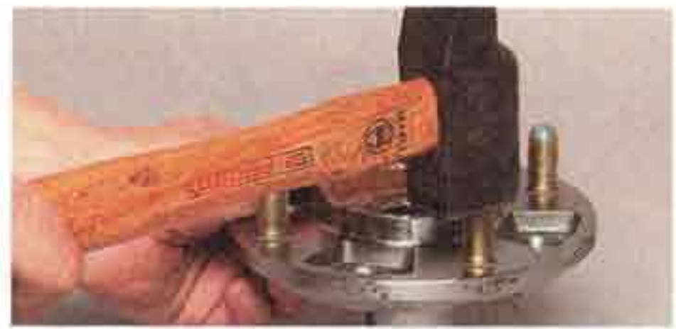
...ударами молотка по торцу шпильки выпрессовываем ее из ступицы.
