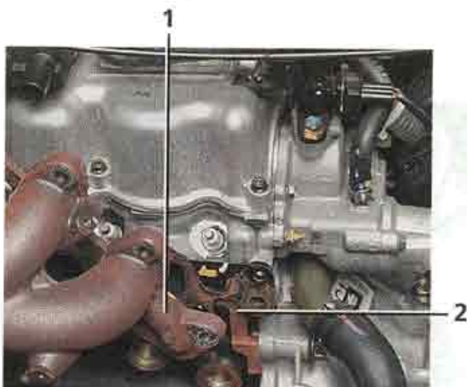
Расположение каналов подвода отработавших газов: 1 — канал в выпускном коллекторе; 2 — канал в головке блока цилиндров
