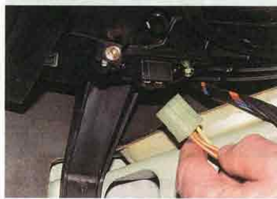
...отсоединяем колодку проводов от резистора (шланг вентиляции электродвигателя для наглядности снят).
