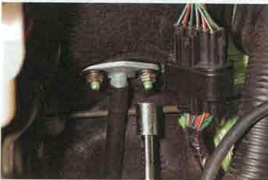
...головкой «на 10» с удлинителем отворачиваем две гайки крепления кронштейна оболочки троса.
