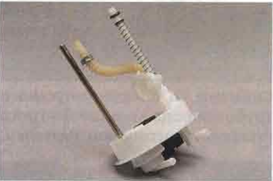
...отсоединяем крышку топливного модуля.
