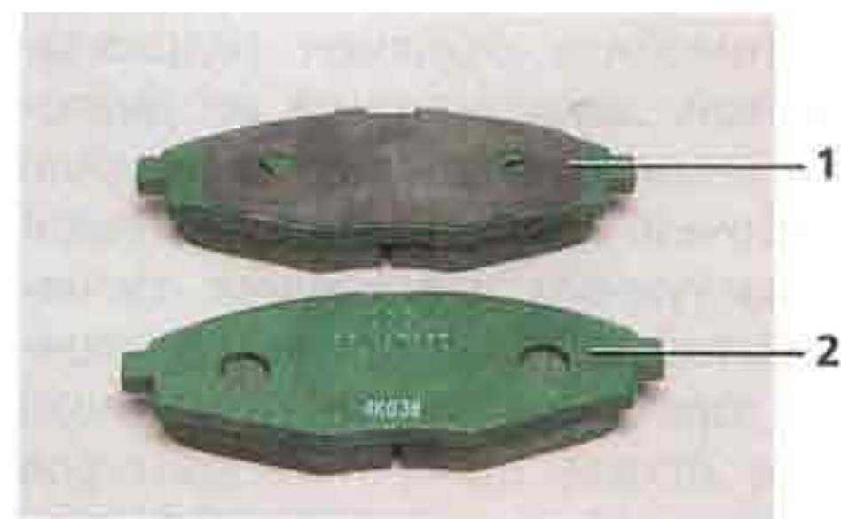
Колодки тормозного механизма переднего колеса: 1 — наружная колодка с противоскрипной пластиной; 2 — внутренняя колодка
