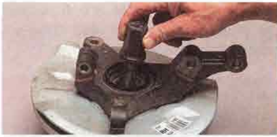
Вставляем в отверстие ступицы цилиндрическую часть оправки с буртиком так, чтобы буртик упирался в торец ступицы.
