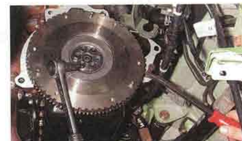
Удерживая маховик от проворачивания монтажной лопаткой, вставленной между зубьями венца маховика и опирающейся на болт, головкой «на 14» отворачиваем шесть болтов крепления маховика.
