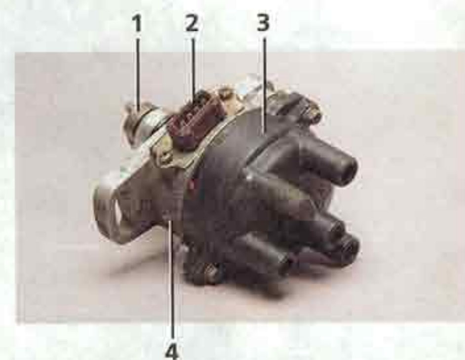
Датчик-распределитель зажигания: 1 — муфта привода вала; 2 — контактный разъем оптического датчика; 3 — крышка; 4 — корпус
