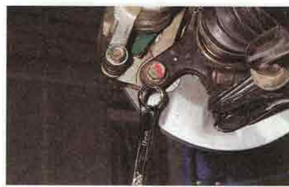
Ключом «на 17» отворачиваем два болта крепления направляющей колодок к поворотному кулаку.
