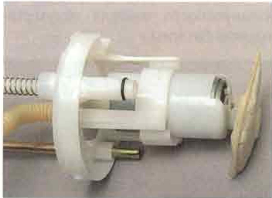
...и надеваем его на направляющую держателя топливного насоса.
