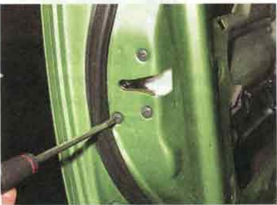
Крестообразной отверткой отворачиваем три винта крепления замка.
