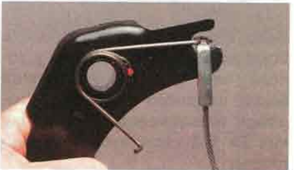
...и заводим ее конец в прорезь педали так, чтобы он оказался поверх наконечника троса привода сцепления.
