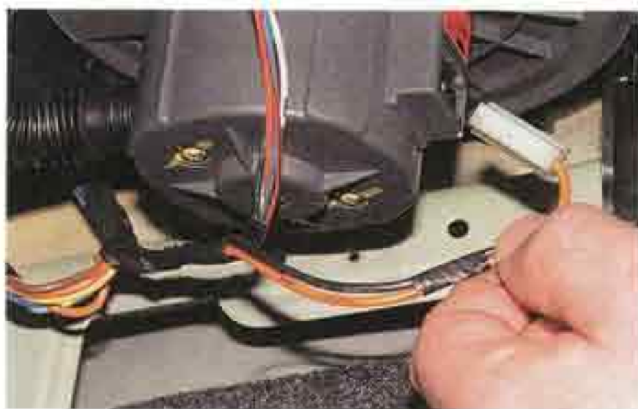
...отсоединяем колодку проводов от электродвигателя вентилятора.
