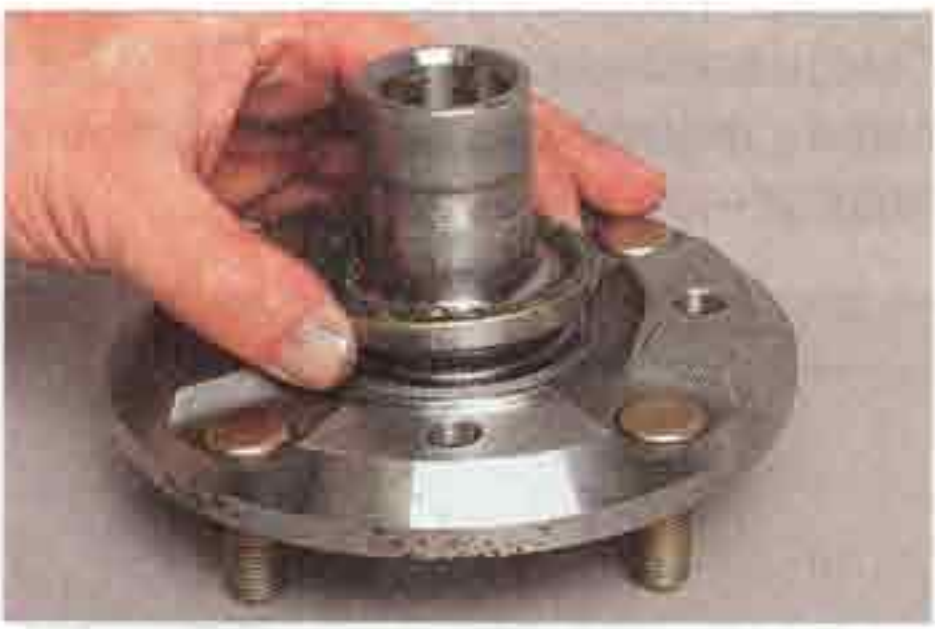
Снимаем сальник со ступицы. Если резьба на шпильке крепления колеса имеет повреждение, ее следует заменить новой. Для этого кладем ступицу колеса на металлический упор или губки тисков и...
