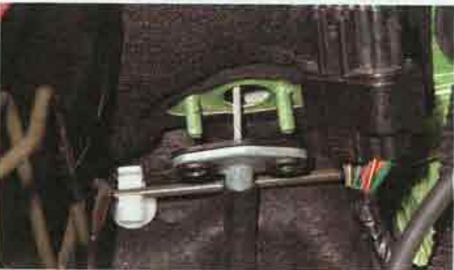
Снимаем кронштейн со шпилек... ...и выводим наконечник троса из отверстия в щитке передка.
