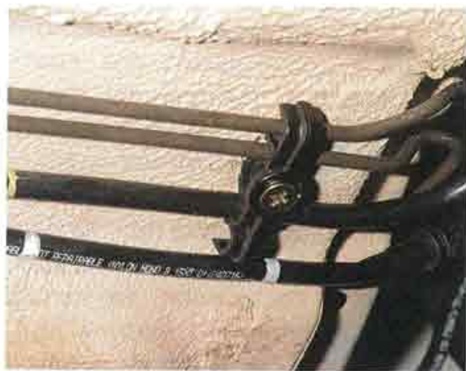
Вынимаем трубку подвода топлива к двигателю из держателя. Нажимаем фиксатор наконечника трубки подвода топлива...
