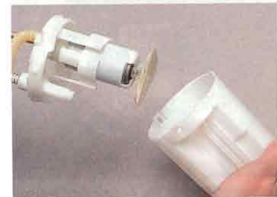
...и вынимаем из корпуса держатель вместе с топливным насосом.
