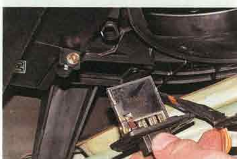
...и снимаем дополнительный резистор. Устанавливаем дополнительный резистор вентилятора отопителя в обратной последовательности.
