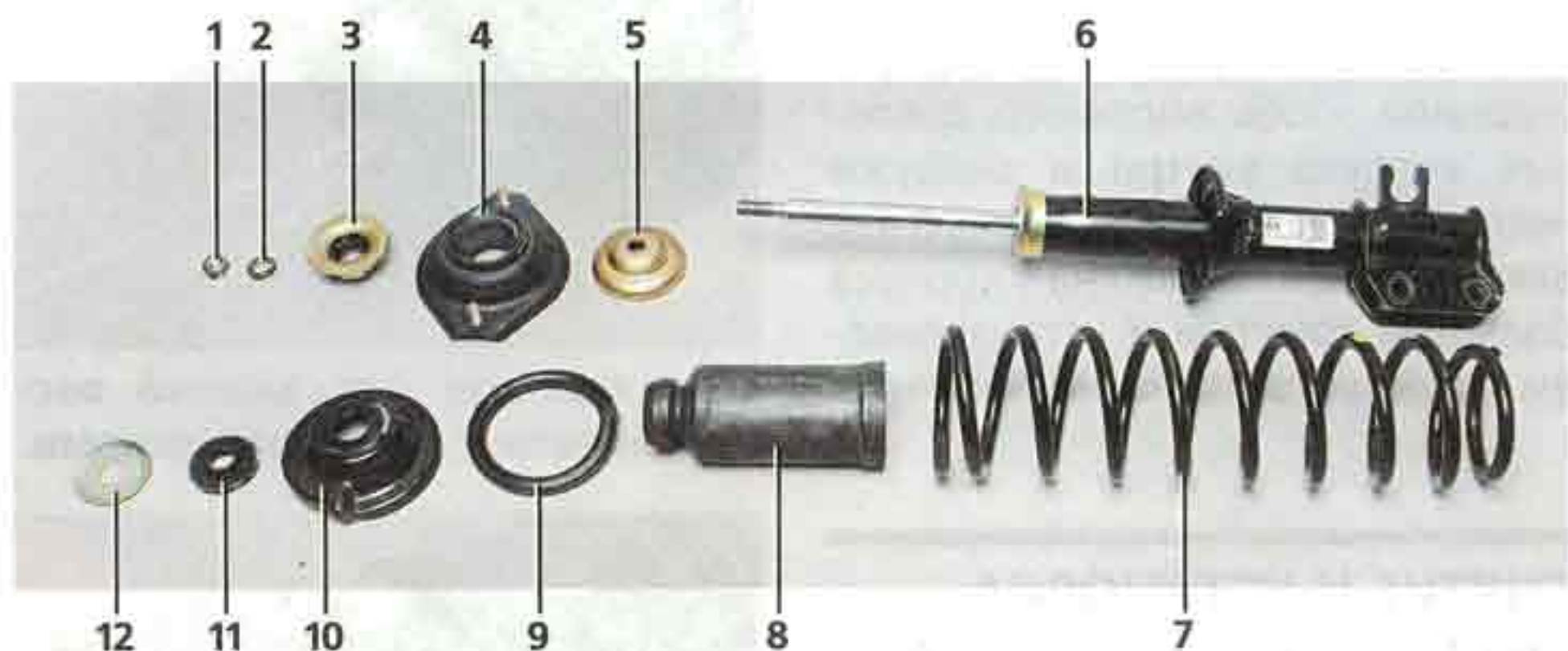
Детали амортизаторной стойки: 1 — гайка штока амортизатора; 2 — пружинная шайба; 3 — ограничительная шайба стойки; 4 — верхняя опора стойки; 5 — чашка опоры стойки; 6 — корпус амортизатора; 7 — пружина; 8 — защитный кожух с буфером сжатия; 9 — прокладка пружины; 10 — верхняя опорная чашка пружины; 11 — подшипник; 12 — опорная шайба подшипника
