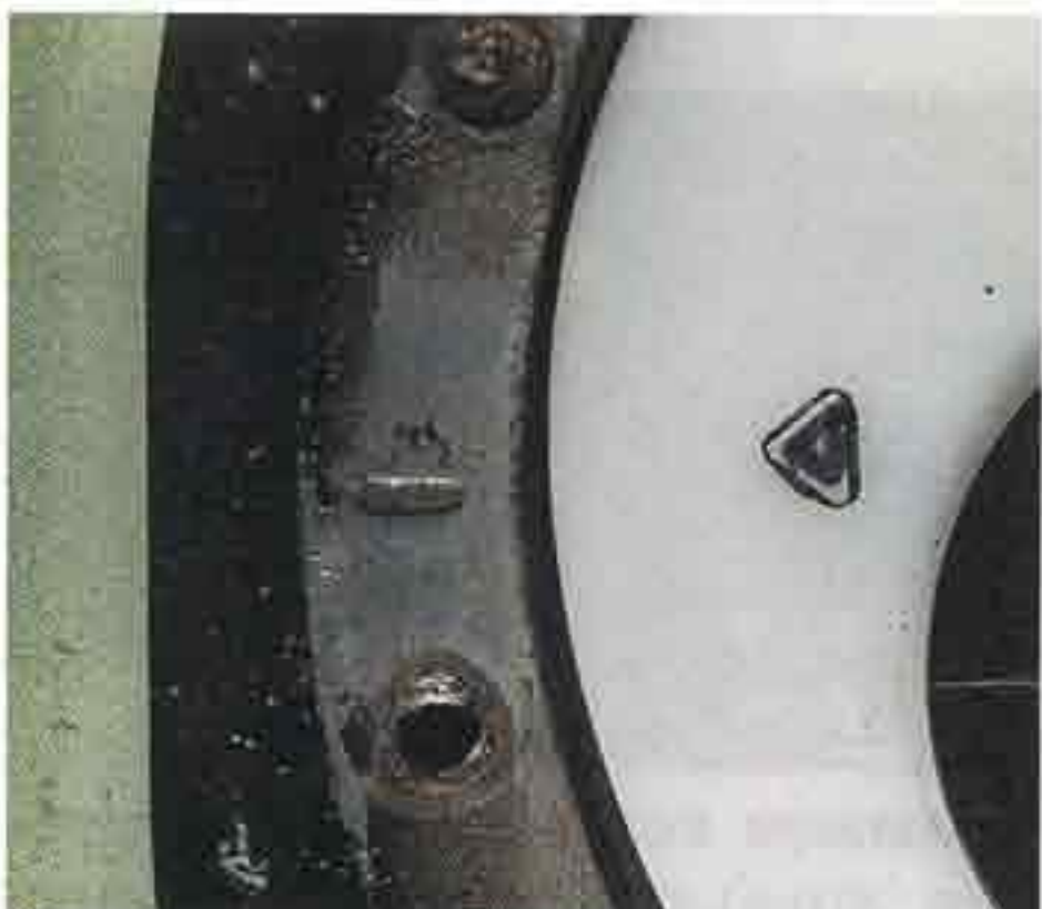
...ориентируем его так, чтобы стрелка на крышке модуля была направлена в сторону задней части автомобиля и совпадала с меткой (риской) на фланце топливного бака.
