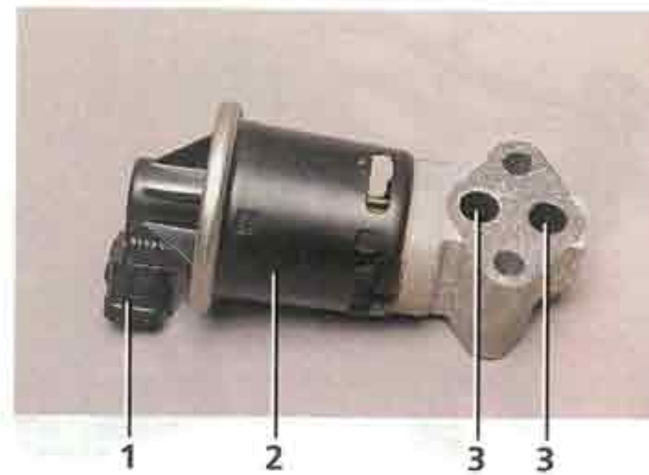
Электромагнитный клапан рециркуляции отработавших газов: 1 — разъем клапана; 2 — корпус клапана; 3 — отверстие для прохождения отработавших газов
