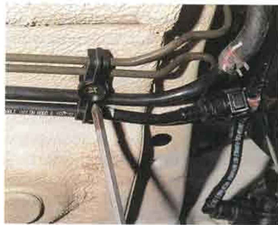
...крестообразной отверткой отворачиваем на несколько оборотов винт крепления держателя тормозных и топливных трубок.
