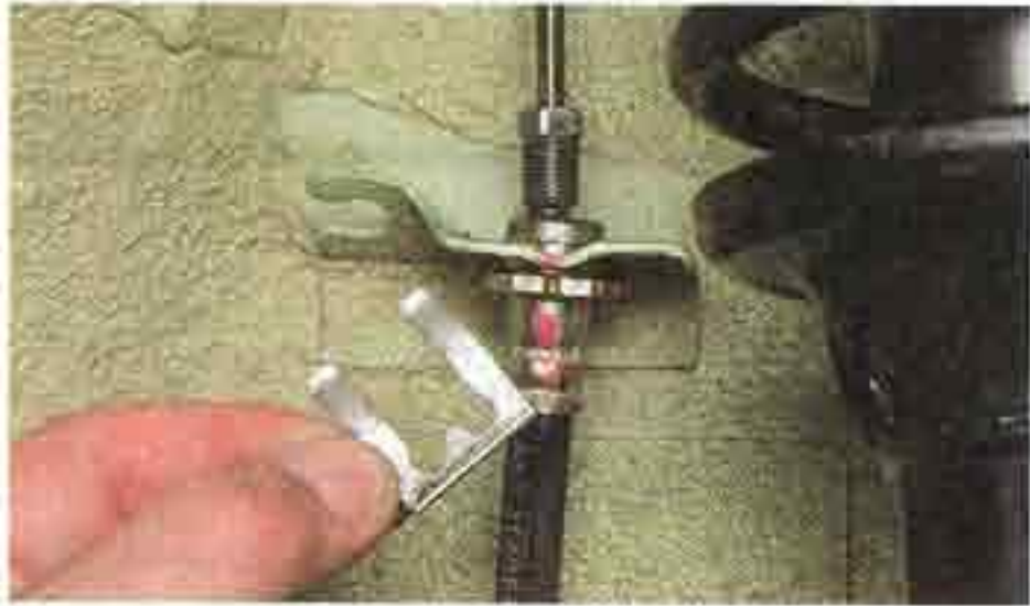
...снимаем фиксатор наконечника шланга.
