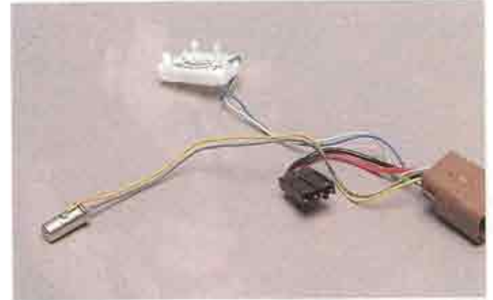
...и снимаем датчик указателя уровня топлива в сборе с колодками проводов и резистором контрольной лампы резерва топлива.
