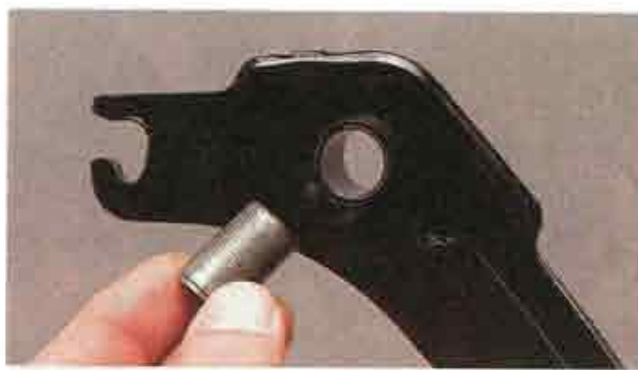
Из снятой педали извлекаем втулку. В моторном отсеке...
