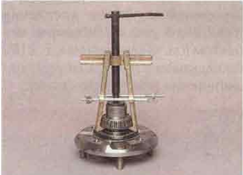
Двухзахватным съемником спрессовываем со ступицы внутреннее кольцо наружного подшипника с сепаратором и роликами.
