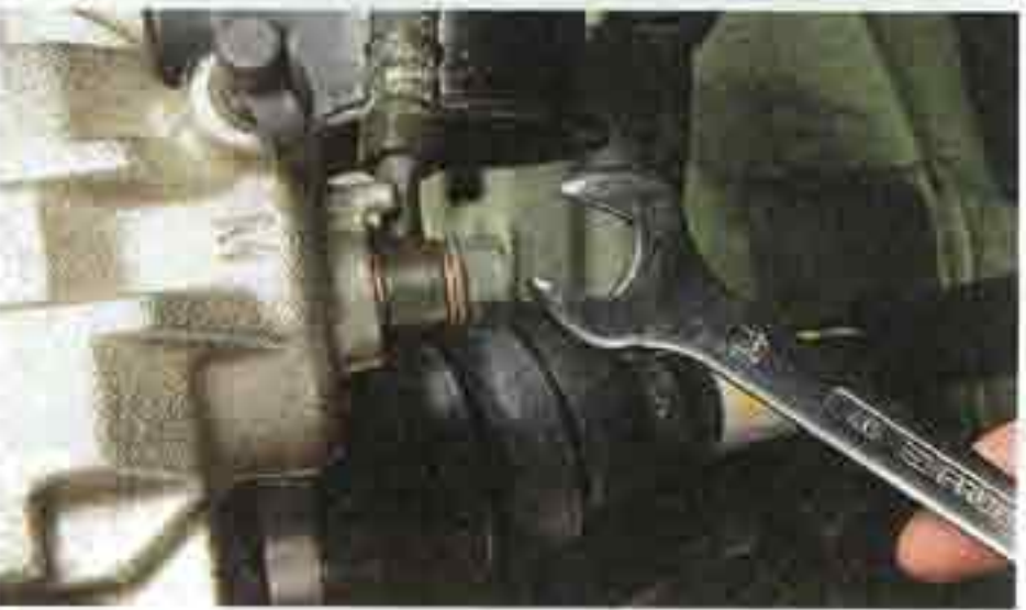
Ключом «на 14» отворачиваем болт-штуцер крепления наконечника шланга к суппорту.
