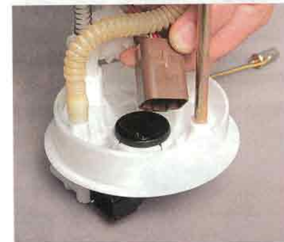
Отсоединяем колодку проводов от разъема на внутренней стороне крышки топливного модуля.
