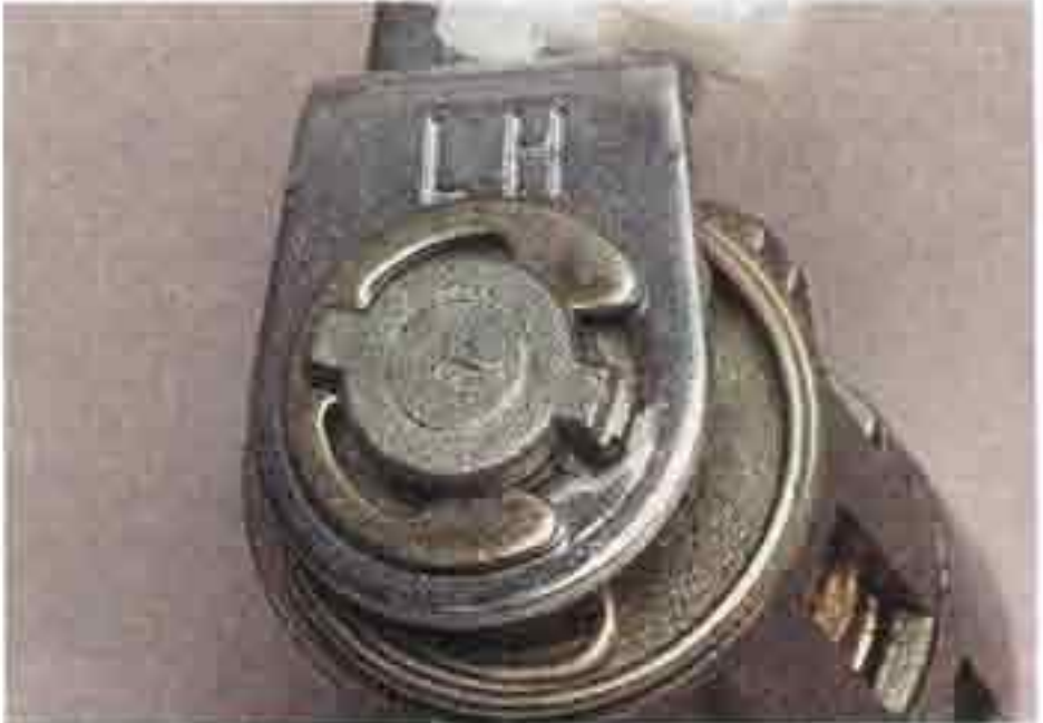
Цилиндрический механизм замка наружной ручки левой двери имеет маркировку LH...
