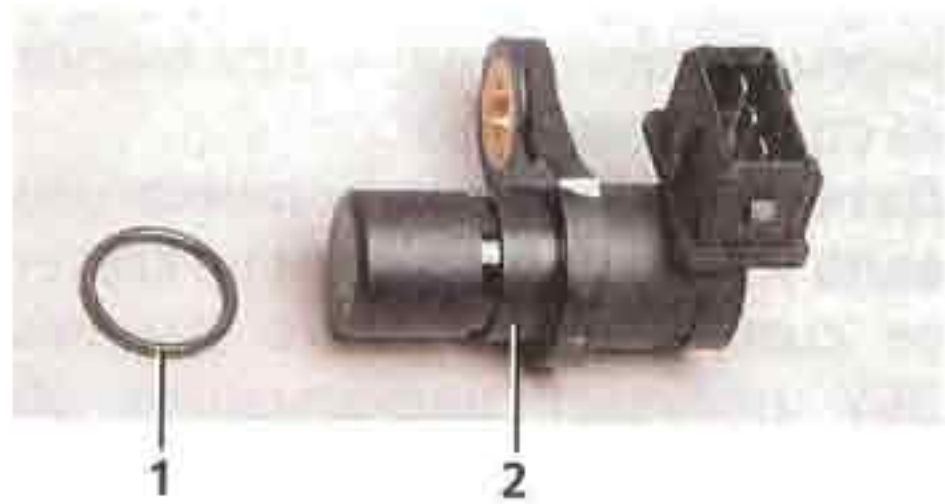
Датчик положения распределительного вала: 1 — уплотнительное кольцо; 2 — датчик
