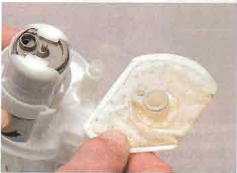
...снимаем сетчатый фильтр со штуцера и установочного штифта топливного насоса.
