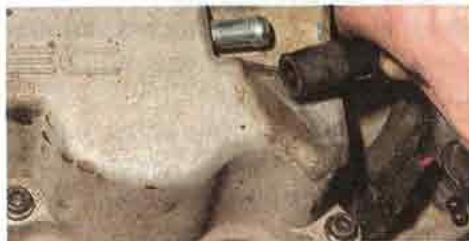
Отсоединяем шланг вентиляции картера от штуцера на крышке головки блока цилиндров.
