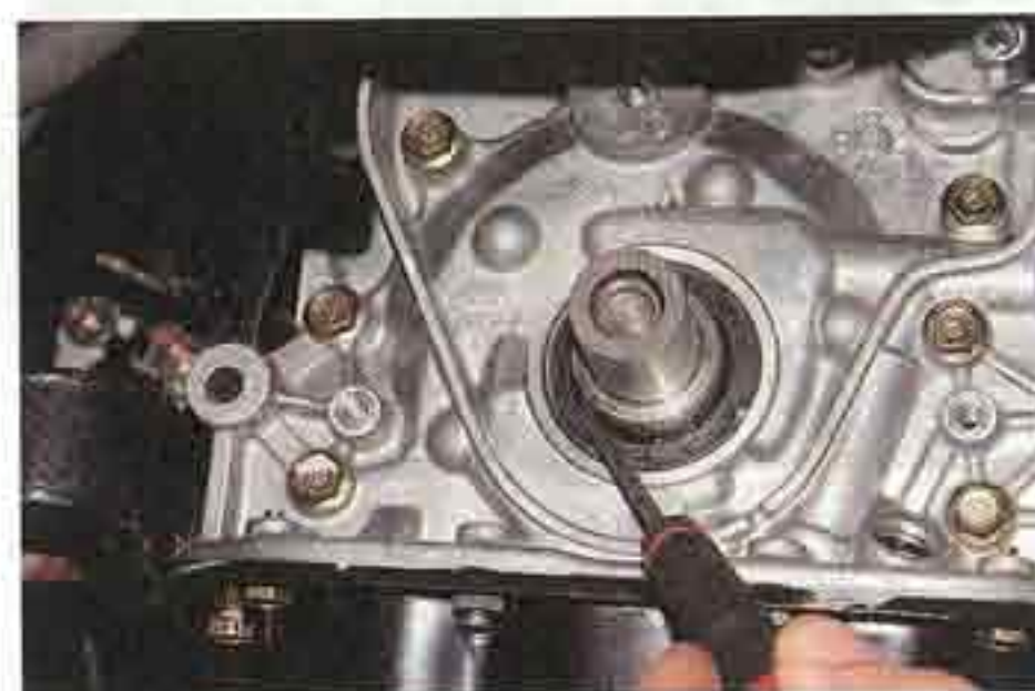
Поддеваем сальник отверткой...
