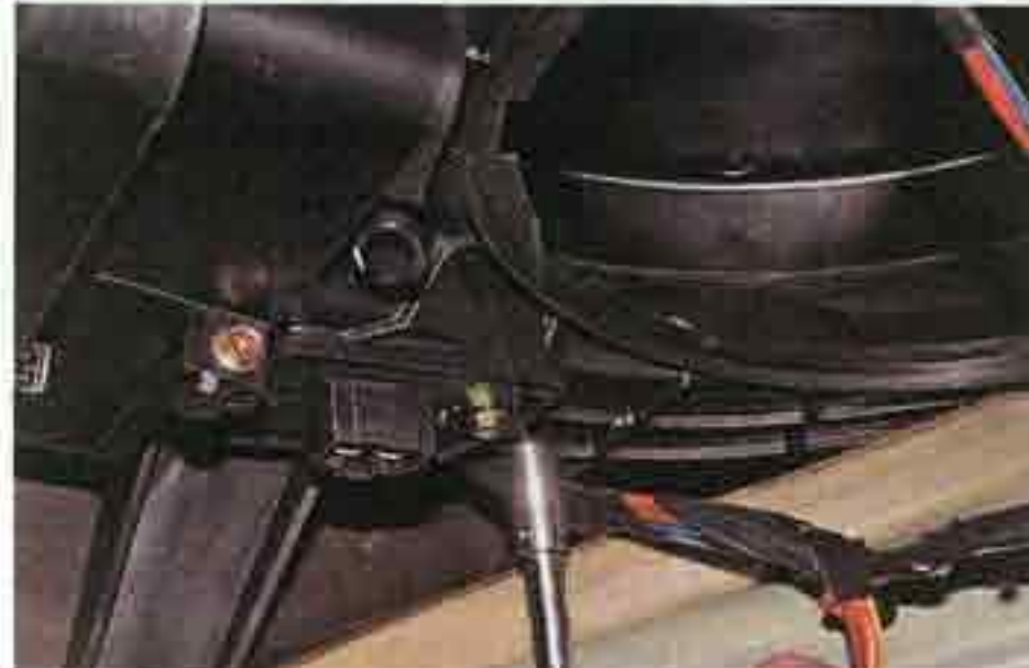
Головкой «на 7» или крестообразной отверткой отворачиваем два самореза...
