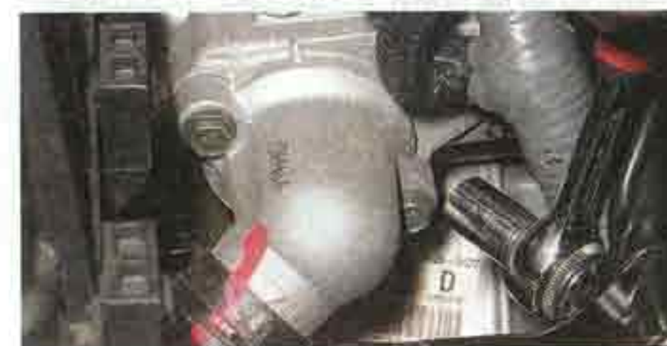
Головкой «на 10» отворачиваем два болта крепления крышки термостата к проставке головки блока цилиндров.
