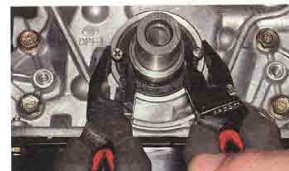
Ухватившись пассатижами за головки саморезов, вытягиваем сальник.
