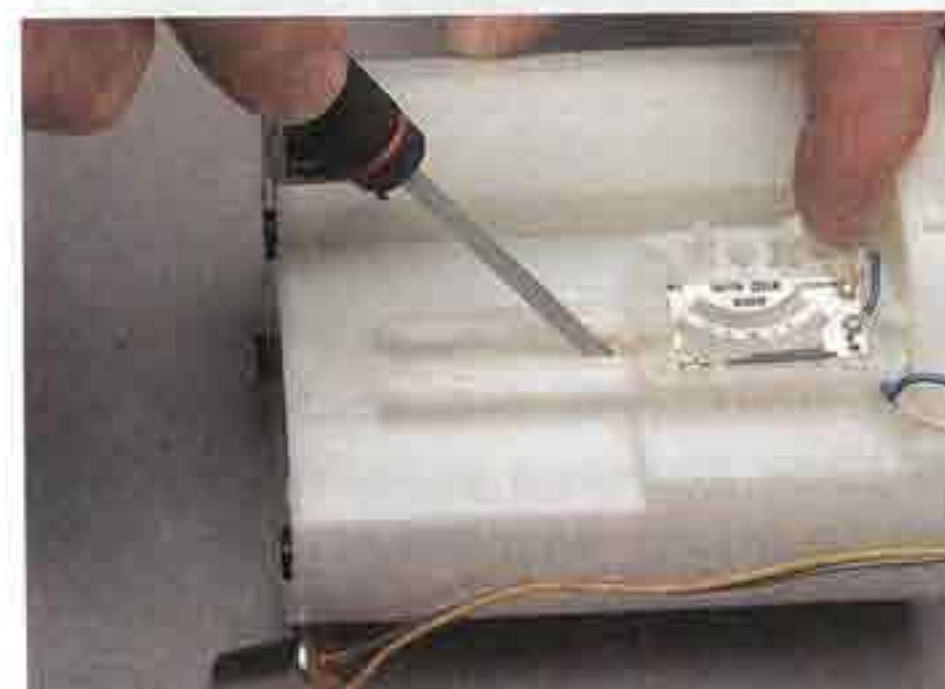
...отверткой отжимаем вбок одну из его направляющих.
