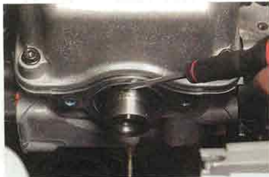
Отверткой поддеваем сальник распределительного вала...
