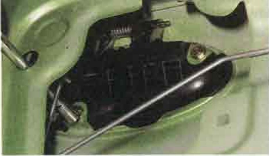
Головкой «на 10» с удлинителем отворачиваем два болта крепления наружной ручки к передней двери...
