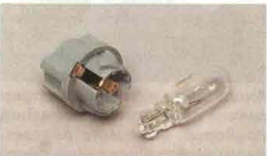
Лампа резерва топлива в баке внешне одинакова с другими контрольными лампами, но имеет мощность 3 Вт и установлена в патрон серого цвета. Устанавливаем комбинацию приборов в обратной последовательности.
