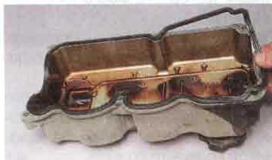
В пазу крышки остается резиновая прокладка. Снимаем ее...
