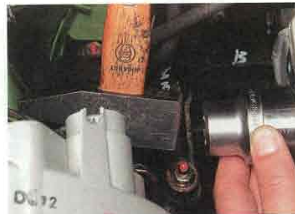
Запрессовываем новый сальник легкими ударами молотка через инструментальную головку или отрезок трубы подходящего диаметра.
