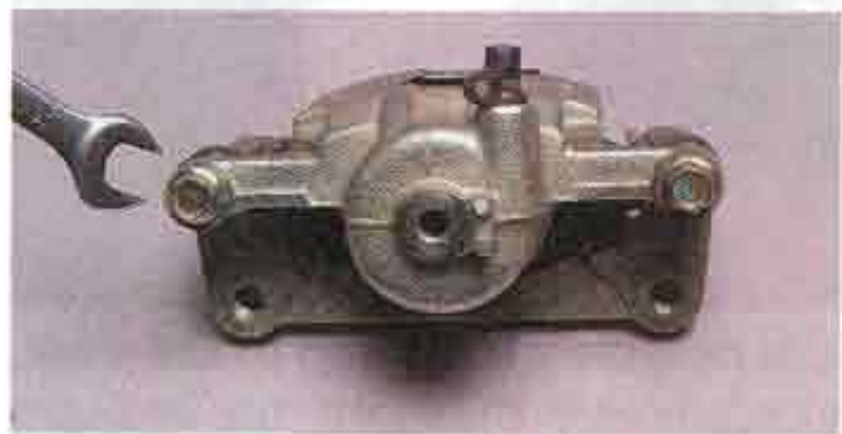
Ключом «на 14» отворачиваем два болта крепления суппорта к направляющим пальцам...
