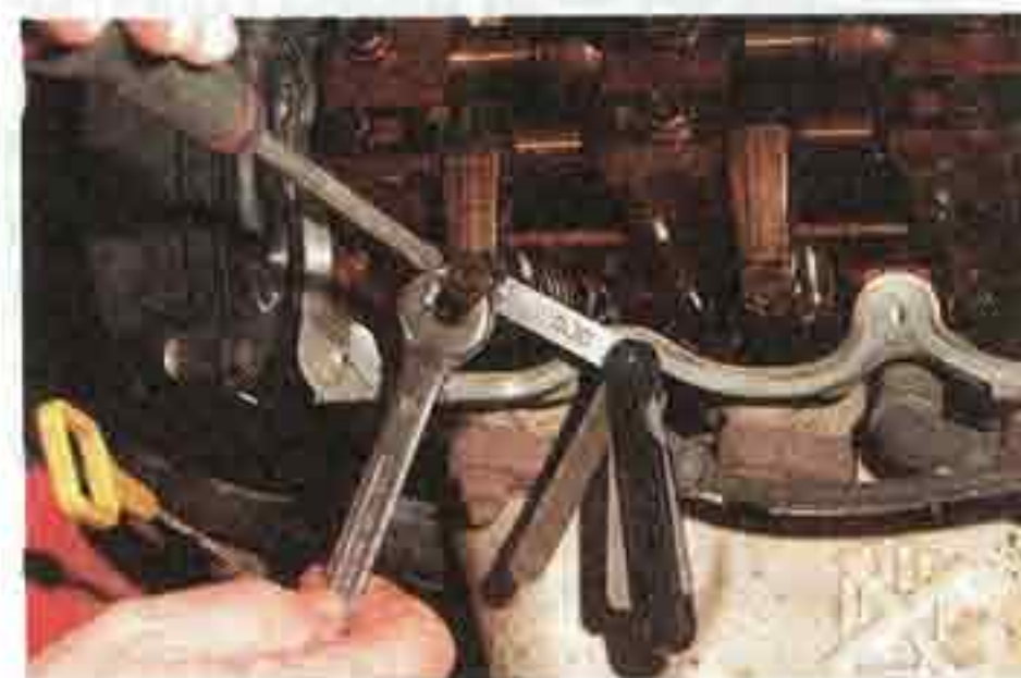
...ключом «на 12» ослабляем затяжку контргайки, удерживая регулировочный винт от проворачивания отверткой.
