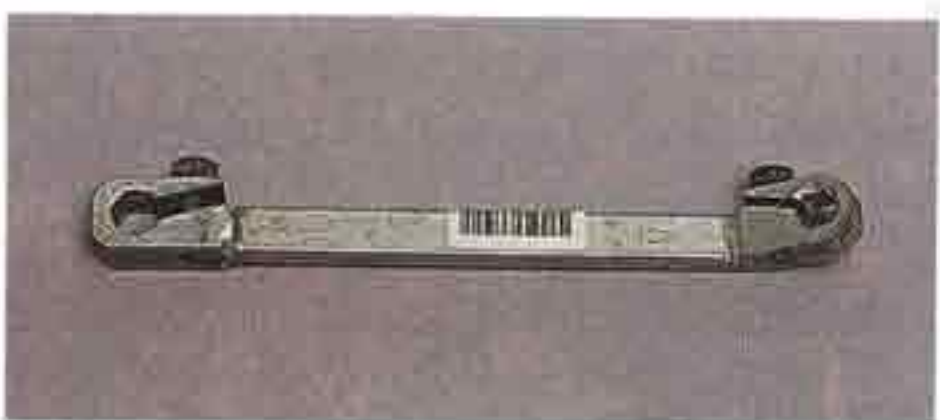
Ключ для отворачивания штуцеров тормозных трубок и штуцеров для прокачки гидропривода тормозов
