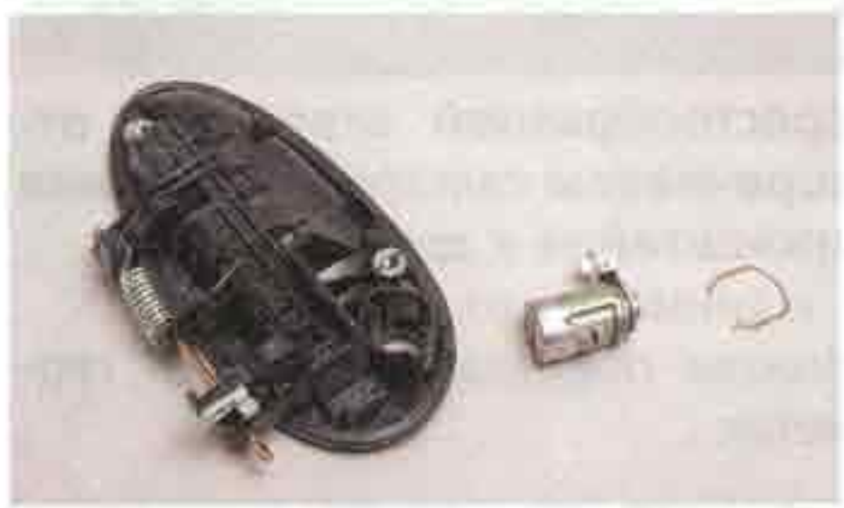
...и вынимаем цилиндрический механизм замка из наружной ручки.
