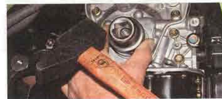
Запрессовываем сальник легкими ударами молотка через инструментальную головку или отрезок трубы подходящего диаметра.
